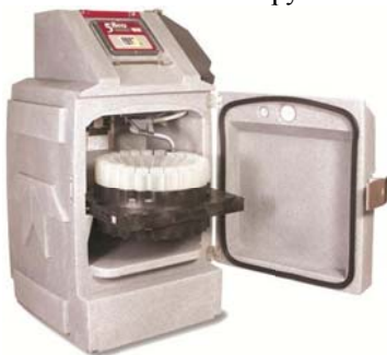
Выдвижные подвес для сосудов и бегунок распределителя обеспечивают доступ к сосудам без помех.
