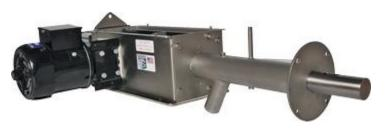
Во время отбора пробы пробоотборный зонд с помощью пневмоцилиндра вводится в объем материала, при этом определенное количество материала через отверстие попадает внутрь зонда. Затем зонд возвращается обратно, и включается шнек, который проталкивает пробу к выходному отверстию. В перерывах между отбором пробы пробоотборный зонд полностью выходит из пневмолинии и не препятствует движению материала в ней.
